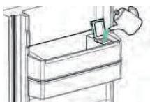
2. Encha o depósito com água potável até a um máximo de 3 litros conforme indicado na linha limite.
