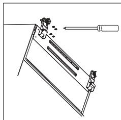
6. Kada je uređaj postavljen, postavite vrata na način suprotan uklanjanju.
