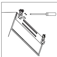
6. Depois de ter o aparelho posicionado, instale as portas seguindo o processo revertido.
