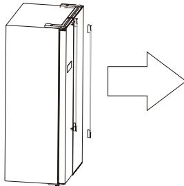
3. Nakon što je uređaj pozicioniran, ponovo postavite ručke.
