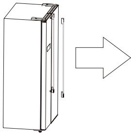
3. Após posicionar o aparelho estiver, volte a colocar as maçanetas seguindo o processo revertido.
