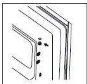
7. Zarotirajte vrata zamrzivača i postavite šarku na levu stranu, zatim pričvrstite vrata.
