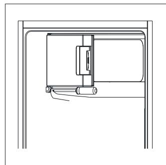
8. Desatornille la bisagra inferior, luego retire las patas ajustables de ambos lados.
