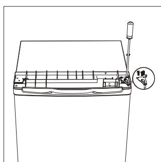
4. Desparafuse a dobradiça inferior da porta do congelador, de seguida, retire a porta e coloque-a numa superfície macia para evitar riscos ou outros danos.
