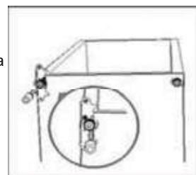
11. Stavite vrata, i provjerite da li dolazi do okomitog i horizontalnog podudaranja i da li su zaptivke dobro zatvorene.
