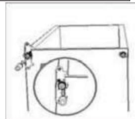
11. Stavite vrata, i proverite da li dolazi do vertikalnog i horizontalnog podudaranja i da li su zaptivke dobro zatvorene.
