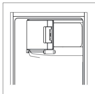
8. Desaparafuse a dobradiça inferior e de seguida remova os pés ajustáveis de ambos os lados
