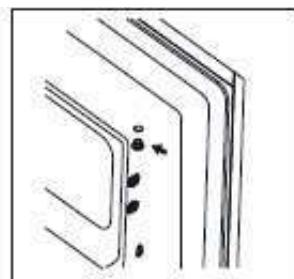
7. Zarotirajte vrata zamrzivača i postavite šarku na lijevu stranu, zatim pričvrstite vrata.
