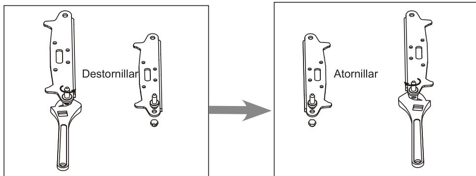
10. Vuelva a colocar el soporte colocando el perno de la bisagra inferior. Reemplace ambos pies ajustables.
