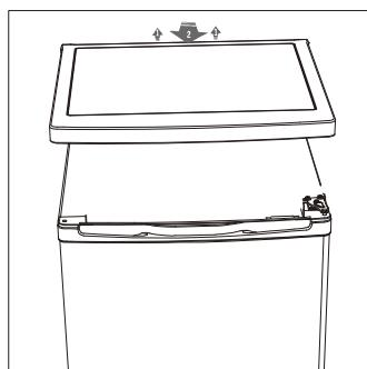
3. Desparafuse a dobradiça superior, de seguida retire a porta e coloque-a numa superfície macia para evitar riscos ou outros danos.
