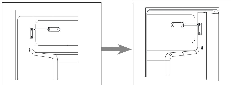
6. Mueva la tapa del orificio de la bisagra del lado izquierdo al derecho.
