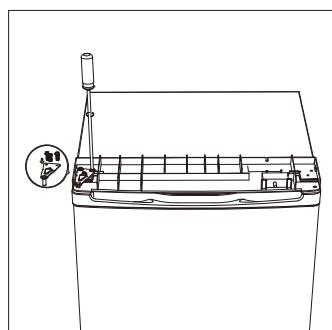
12. Coloque a tampa superior e fixe-a com dois parafusos na parte traseira.
