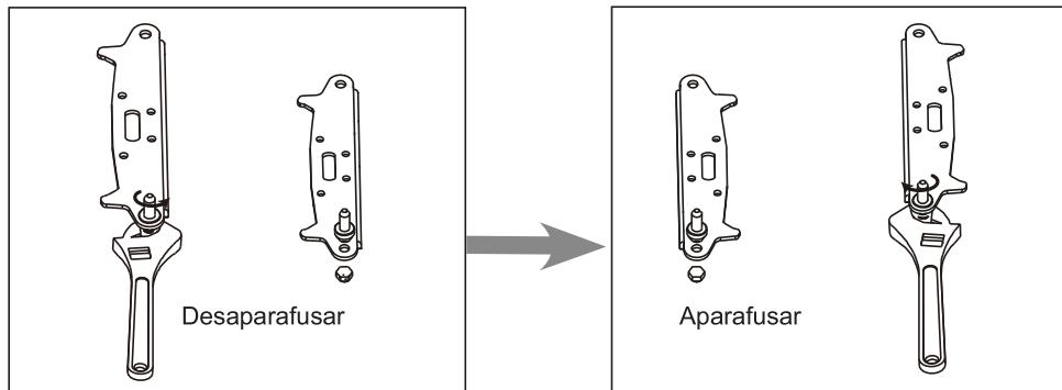
10. Reinstale o suporte encaixando na cavilha da dobradiça inferior. Substitua os dois pés ajustáveis
