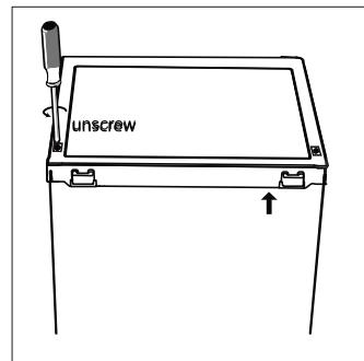
2. Retire la cubierta superior y déjela a un lado.
