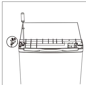
12. Coloque la tapa superior y fíjela con 2 tornillos en la parte posterior.
