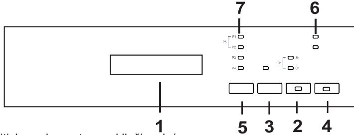
Pritiskom dugmeta za uključivanje/isključivanje(**4**), uključite mašinu. Lampice za uključivanje/isključivanje svete dok je mašina uključena. Izaberite odgovarajući program pritiskom dugmeta za izbor programa(**5**).
