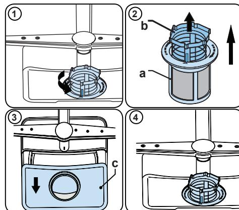
Da biste uklonili i očistili kombinaciju filtera, okrenite je u smeru suprotnom od kazaljke na satu i izvadite je podižući prema gore (1). Izvucite grubi filter iz mikro filtera (2). Zatim izvucite i uklonite metalni filter (3). Isplaknite sa mnogo vode dok se ne očiste ostaci. Ponovo sklopite filtere. Zamenite uložak filtera, i okrenite ga u smeru kazaljki na satu (4).
