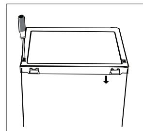
13. Odvojite brtve na vratima hladnjaka i zamrzivača, a zatim ih stavite ponovo nakon rotiranja.
