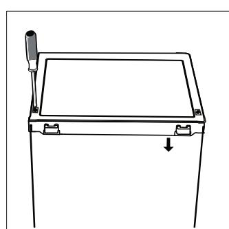
13. Odstranite tesnilni hladilnega in zamrzovalnega oddelka, ju obrnite in ponovno namestite.
