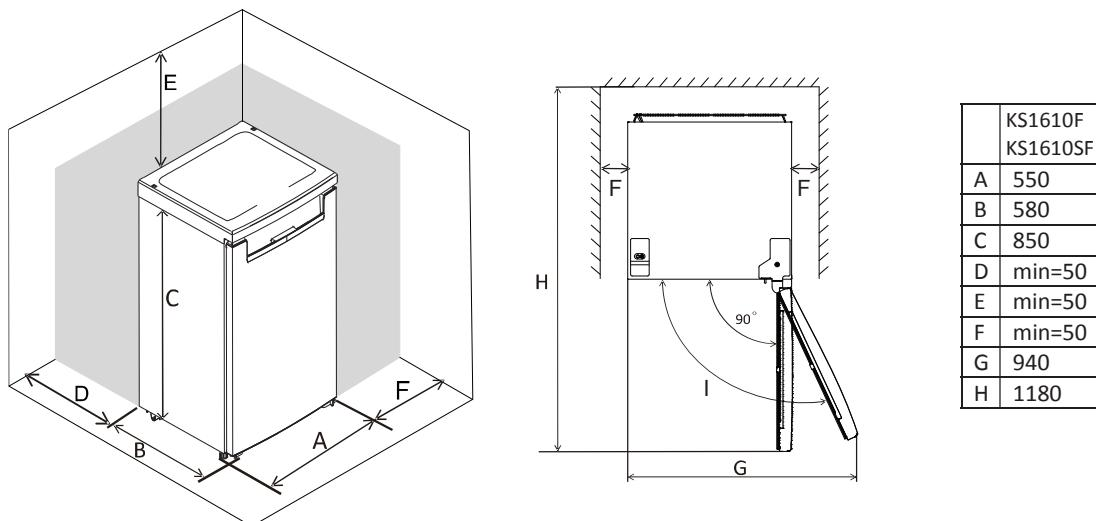
**Nota:** Este aparato de refrigeración no está diseñado para ser utilizado como un aparato integrado.
