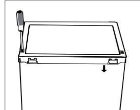
13. Odvojite zaptivke na vratima frižidera i zamrzivača, a zatim ih stavite ponovo nakon rotiranja.
