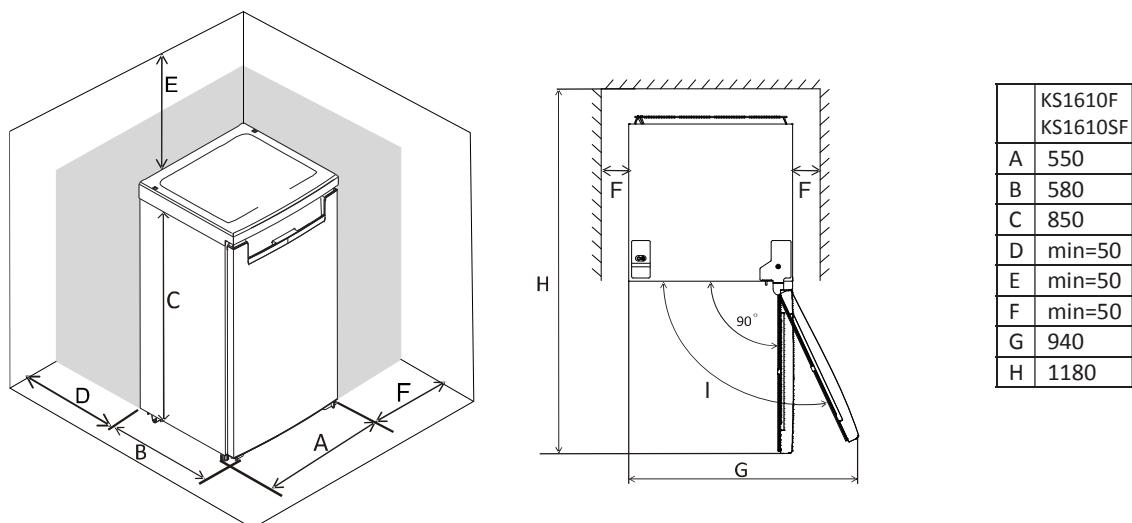
Nota: Este aparelho de refrigeração não se destina a ser usado como um aparelho embutido.
